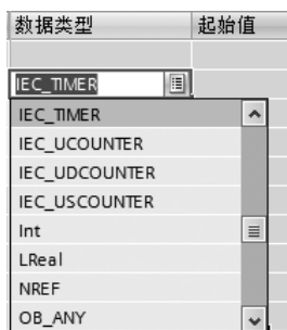
图 3-13 三个定时器 IEC_TIMER 的选择界面
