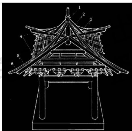
图 1-2 宋式簇角梁构架
