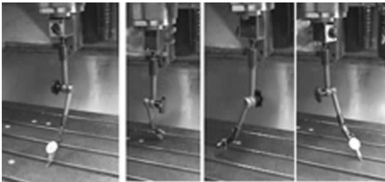
图 2-6 主轴中心相对于工作台的垂直度的检验
