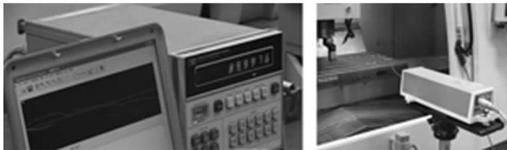
图 2-12 使用双频激光干涉仪测量位置精度
