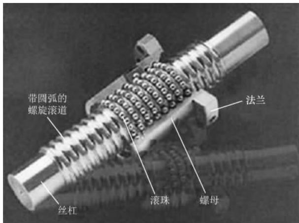
图 2-20 滚珠丝杠螺母副结构
