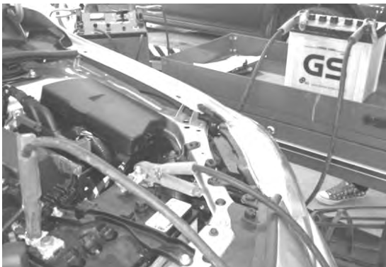
图 1-1-6 蓄电池的并联拆卸
