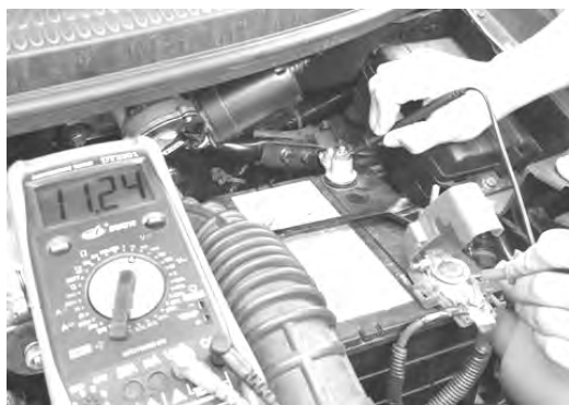
图 1-1-5 检查蓄电池起动电压
