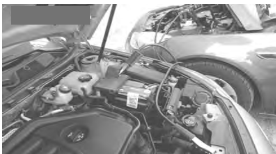
图 1-1-7 蓄电池并联起动的电缆连接
