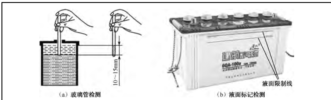
图 1-1-9 蓄电池的液面高度检查
