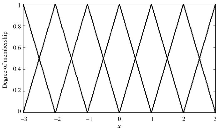
图 3-8 由三角形隶属函数构成的模糊系统
