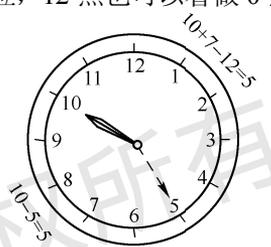
图 1-1 说明补码运算原理的实例图
