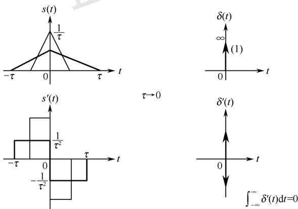
图 1.3-8 冲激偶函数的图解
