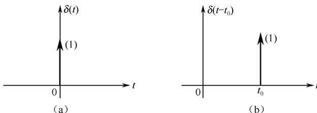
图 1.3-7 单位冲激信号和移位的单位冲激信号
