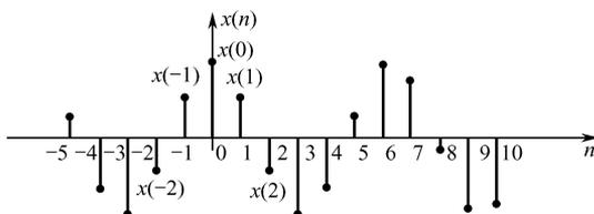
图 1.5-2 离散时间信号的图形表示
