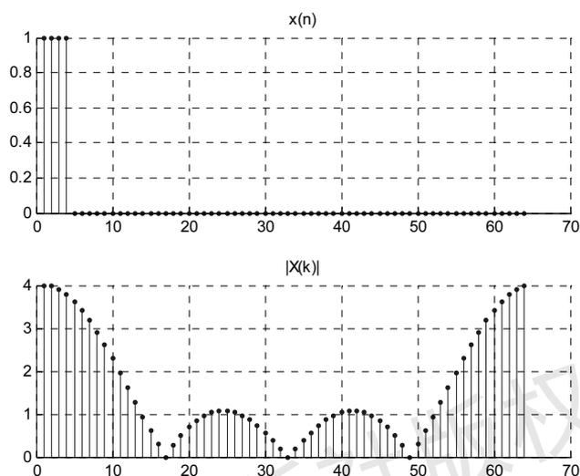
图 3.4 DIT-FFT 算法波形
