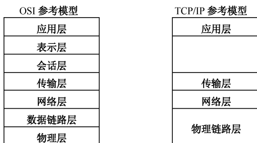
图 1-2 OSI 参考模型与 TCP/IP 参考模型的对照
