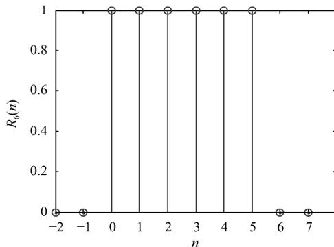
图 1-4 矩形序列  $R_6(n)$  的波形
