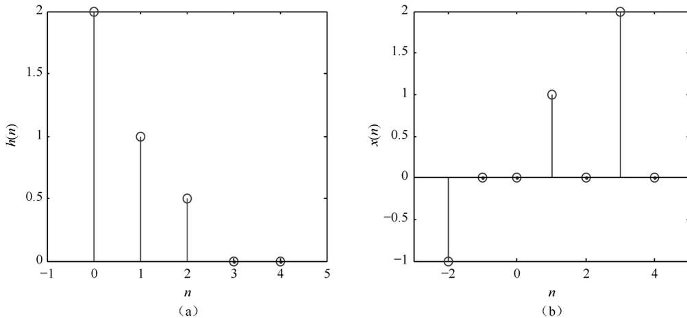
图 1-13 线性移不变系统的单位脉冲响应  $h(n)$  和输入序列  $x(n)$
