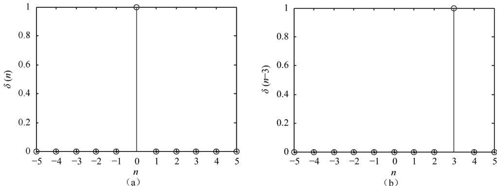
图 1-2 单位脉冲序列及其平移后的波形
