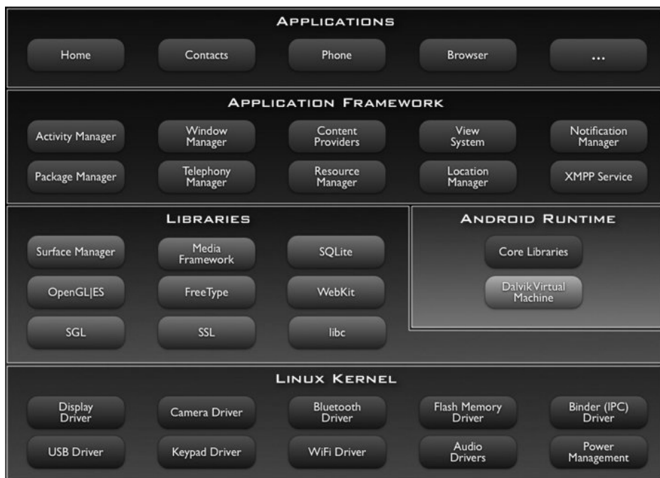
图 1-1 Android 系统的体系结构
