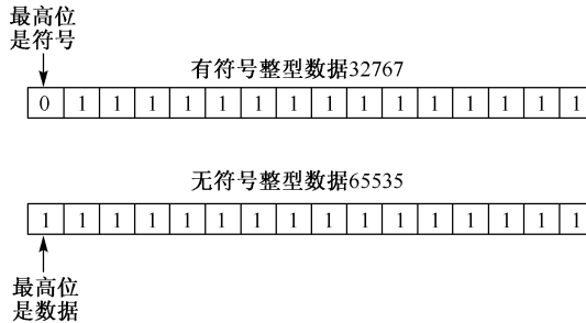
图 1.2.2 有无符号短整型数据的存储情况
