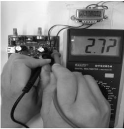
如图所示,测量电源变压器次级电压,应选择直流电压挡。( )                           |    | 2    | 2  | 1111 |
