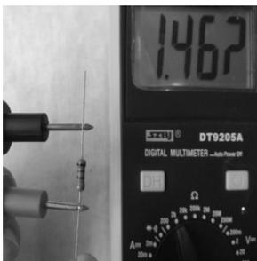
如图所示，万用表测量电阻的方法属于（ ）。<br>A. 直接测量法<br>B. 间接测量法<br>C. 组合测量法<br>D. 时域测量法                 |    | 2    | 1  | 1112 |
