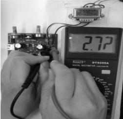
如图所示,测量电源变压器次级电压,应选择交流电压挡进行测量。( )                     |    | 2    | 1  | 1111 |
