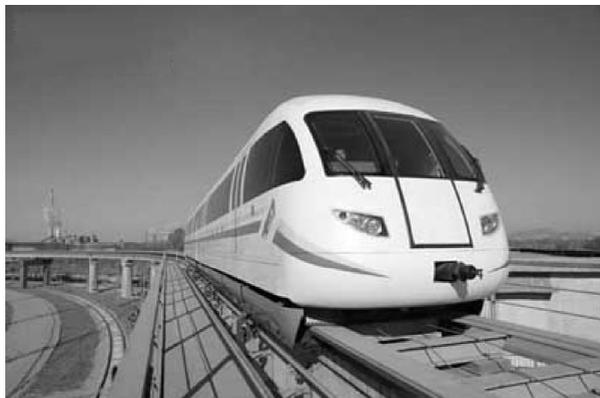
图1-5 北京地铁S1线采用的中低速磁悬浮列车
