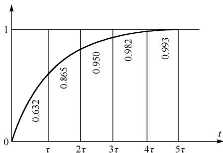
图 1.19 一阶传感器的单位阶跃响应曲线
