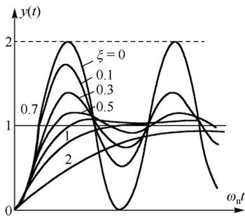
图 1.20 二阶传感器单位阶跃响应曲线
