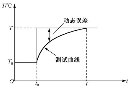
图 1.16 热电偶测温过程的动态特性
