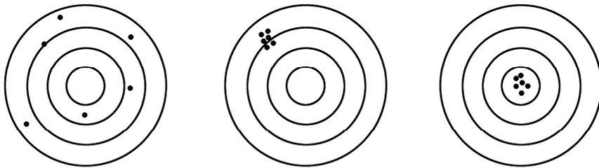
(a) 低精度、低准确度 (机器人 1) (b) 高精度、低准确度 (机器人 2) (c) 高精度、高准确度 (机器人 3)
