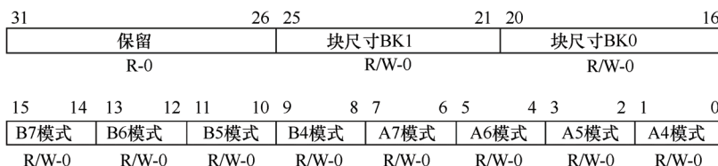
图 2-10 寻址模式寄存器各个字段的定义
