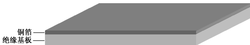
图 2.1.4 单面覆铜板结构
