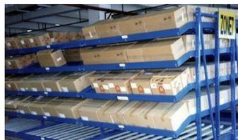
图 4-3 重力式货架
