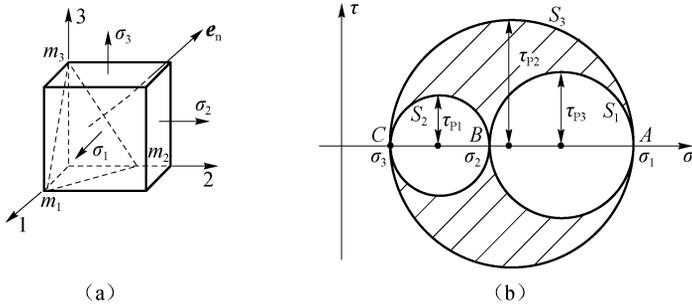
图 2.18 三向应力状态所对应的三向应力圆
