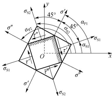
图 2.9 切应力极值所在平面
