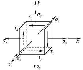
图 2.17 某个主应力已知的三向应力状态
