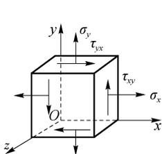
图 2.4 平面应力状态单元体
