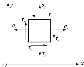
图 2.6 平面应力状态的工程记法
