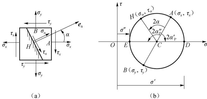
图 2.11 平面应力状态的应力圆
