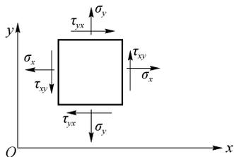
图 2.5 平面应力的表示方法
