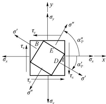
图 2.12 平面应力状态的主应力、主方向和主单元体
