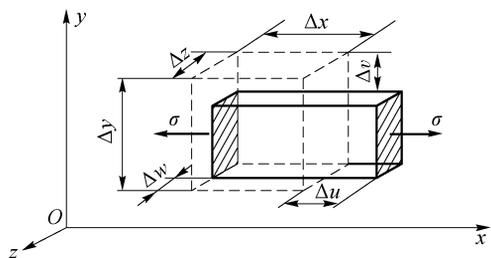
图 2.19 单向应力状态时单元体的变形
